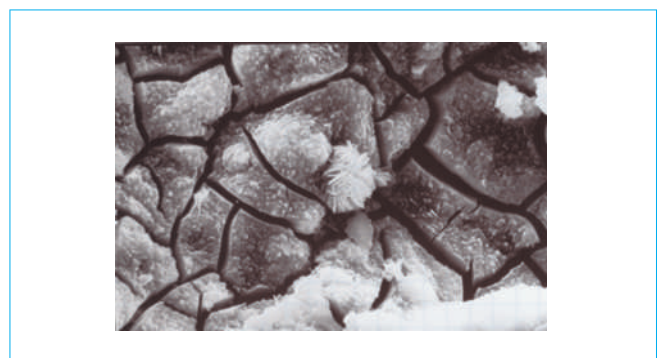
Figure 3 – Image obtenue au microscope électronique à balayage (MEB) par électrons secondaires de gel d'alcali-réaction dans un échantillon de béton
